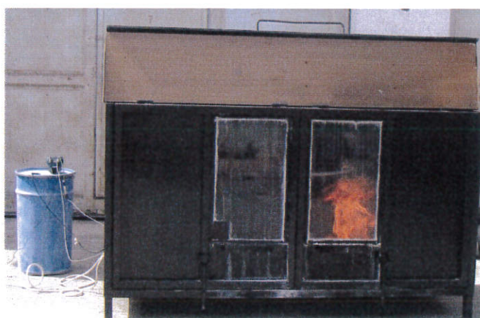
4. 5. számú kép Égő modelltűz, és a lánggal érintkező PROTENG cső
