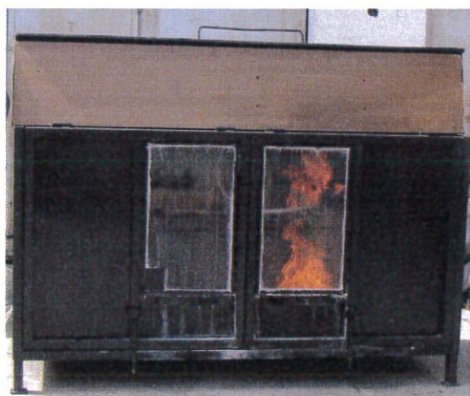
4. 5. számú kép Égő modelltűz, és a lánggal érintkező PROTENG cső
